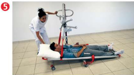
5 Приподнять носилки за 2 петли, чтобы регулируемые ножки шасси подъемника прошли под носилками. Повернуть подъемник так, чтобы было возможно установить носилки на ножки шасси.
